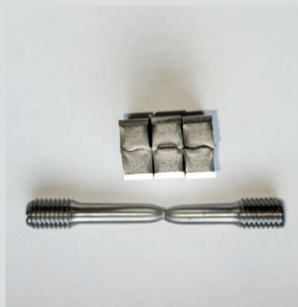
Des tests mécaniques sont effectués pour chaque lot de production et garantissent une traçabilité individuelle de chaque manille.
