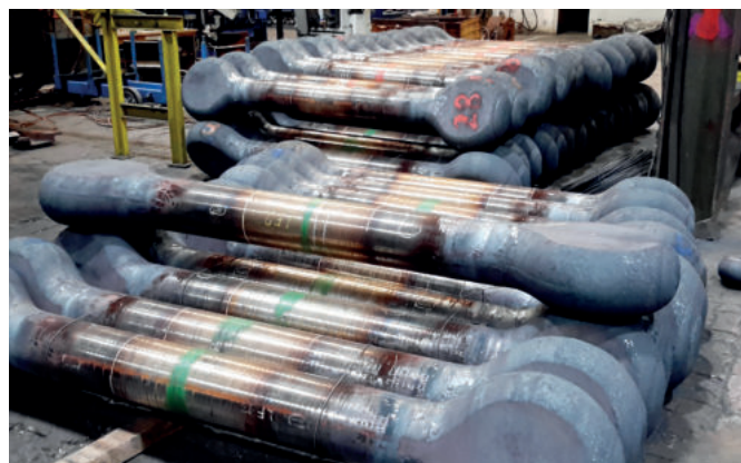
Processus de forgeage zéro déchet : « os de chien »
