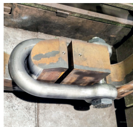
Les manilles sont testées à l'épreuve de charge - (attesté par la société de classification sur demande)
