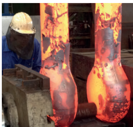
Les dimensions de forgeage de l'arc sont contrôlées et ajustées
