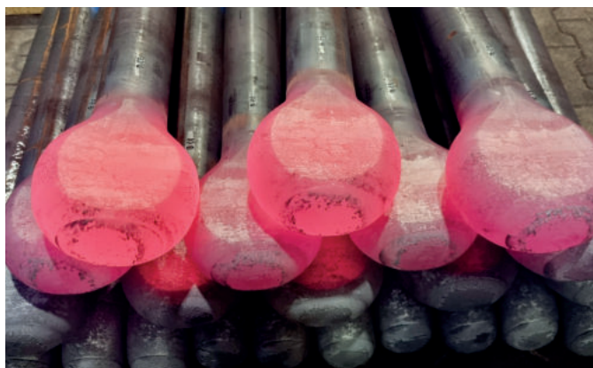
Processus de forgeage zéro déchet : les yeux sont contrariés forgés
